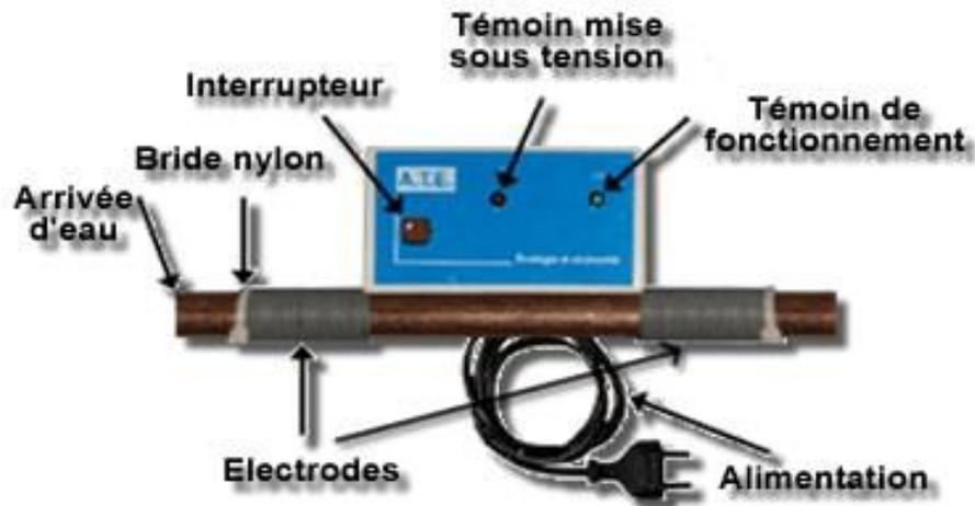
Pour une efficacité optimale, placez votre appareil A.T.E. sur l'arrivée principale d'eau de votre habitation (canalisation cuivre, galvanisée ou PVC) et sur une partie **droite**, avant toute dérivation.
